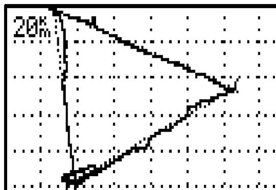
Die Zahl in der linken oberen Ecke ist die Kantenlänge eines Quadrats. Um eine Ausschnittvergrößerung zu erhalten drücken Sie [ENTER]. Es erscheint ein Marker. Bewegen Sie diesen mittels der Pfeiltasten LEFT/RIGHT [<]/[>] und UP/DOWN [^]/[v] in die Nähe des Bereiches, den Sie vergrößern wollen und drücken Sie erneut [ENTER]. Ein zweiter Marker erscheint. Mit diesem ziehen Sie ein Fenster um den gewünschten Bereich auf und bestätigen mit [ENTER]. Sie erhalten nun die Ausschnittvergrößerung.
