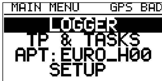
Zuerst soll der Logger auf einen neuen Piloten, ein neues Flugzeug usw. eingestellt werden (Erstellen einer neuen Flight Info). Dies geschieht im Untermenü LOGGER.
