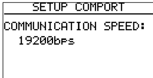
Wählen Sie die Übertragungsgeschwindigkeit mit den Pfeiltasten UP/DOWN [^]/[v].
