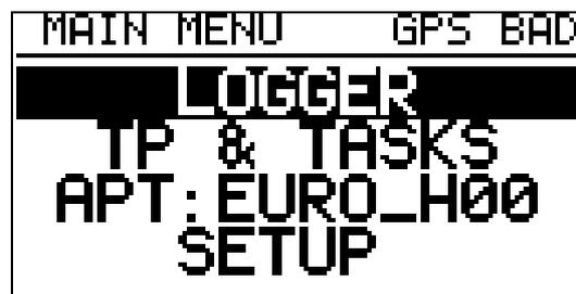
Durch Drücken von [ENTER] erhält man das Menü „FLIGHT SETUP“ mit 8 Unterpunkten, in denen fast alle Einstellungen, die für den Betrieb des Loggers wichtig sind, getätigt werden können.
